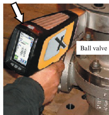
写真 1 可搬型分析装置を用いて分析している様子
